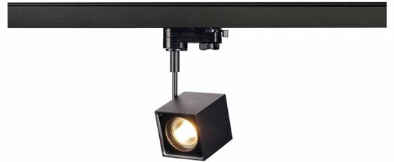
Dreh- und schwenkbarer Hochvoltstrahler ALTRA DICE mit passendem Adapter für das 3Phasen Hochvolt-Schienen-System. Die aus Aluminium gefertigte Leuchte ist durch den verbauten GU10 Sockel für Halogen- sowie LED-Leuchtmittel geeignet. Als Erweiterung der ALTRA DICE Serie stehen Wand-, Deckenleuchten zur Verfügung.+
