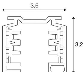
Aluminium Trägerschiene des EUTRAC Hochvolt 3Phasen-Aufbauschiene-Systems. Die Montage kann durch die im Profil vorhandenen Bohrungen direkt an Wand oder Decke erfolgen. Die Aufbauversion dieses Systems ist in mehreren Farben und Längen verfügbar. Alternativ steht des Weiteren eine Einbauversion zur Verfügung. Bitte beachten Sie, dass sich der Weißton ab dem 01. April 2018 von RAL 9010 auf RAL 9016 (Verkehrsweiß) ändert.
