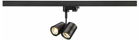
Zweiflammiger, dreh- und schwenkbarer Hochvoltstrahler BIMA 2 mit passendem Adapter für das 3Phasen Hochvolt-Schienen-System. Die aus Aluminium gefertigte Leuchte ist durch die verbauten GU10 Sockel für Halogen- sowie LED-Leuchtmittel geeignet. Die beiden Leuchtenköpfe sind getrennt voneinander frei schwenkbar.+
