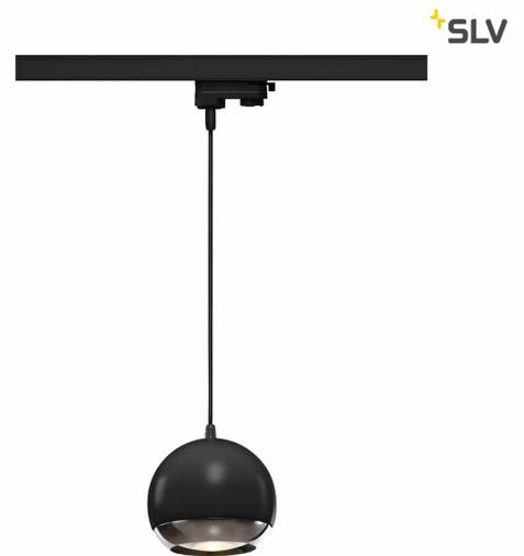
Hochvoltpendelleuchte LIGHT EYE mit passendem Adapter für das 3Phasen Hochvolt-Schienen- System. Die kugelförmige, aus Stahl und textilmanteltem Kabel gefertigte Leuchte ist durch den verbauten GU10 Sockel für Halogen- sowie LED-Leuchtmittel mit einem Durchmesser von 11,1cm geeignet. Die Pendellänge beträgt 1,5m. +
