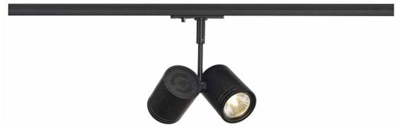
Zweiflammiger, dreh- und schwenkbarer Hochvoltstrahler BIMA 2 mit passendem Adapter für das 1Phasen Hochvolt-Schiene-System. Die aus Aluminium gefertigte Leuchte ist durch die verbauten GU10 Sockel für Halogen- sowie LED-Leuchtmittel geeignet. Die beiden Leuchtenköpfe sind getrennt voneinander frei schwenkbar.
