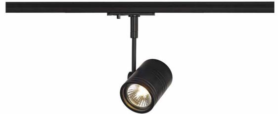
Dreh- und schwenkbarer Hochvoltstrahler BIMA 1 mit passendem Adapter für das 1Phasen Hochvolt-Schienen-System. Die aus Aluminium gefertigte Leuchte ist durch den verbauten GU10 Sockel für Halogen- sowie LED-Leuchtmittel geeignet.+
