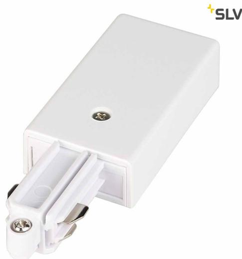
Endeinspeiser für das Hochvolt 1Phasen-Aufbauschienen-System. Der in mehreren Farbversionen verfügbare Einspeiser ist mit Erdleiter links oder rechts erhältlich. Detaillierte Informationen entnehmen Sie bitte der Planungshilfe.
