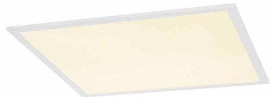
Mit dem in mehreren Lichtfarben erhältlichen I-VIDUAL für 62x62 Raster, bieten wir eine moderne und raumsparende Lösung für eine effiziente Art der Grundbeleuchtung. Aufgrund der variablen Konstant Stromversorgung von 1000mA bis 1050mA können diverse Standard- oder dimmbare Treiber verwendet werden. Mit diesem Produkt erreichen Sie ein angenehmes, homogenes und blendfreies Beleuchtungsempfinden. Hier wird ein Blendwinkel unter 19 erreicht.
