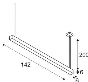
Die Q-LINE DALI Wandleuchte ist wahlweise verfügbar mit weißem, schwarzem oder silbergrauem Leuchtengehäuse ausgestattet. Ein unterseitig angebrachter Diffusor aus Acrylglas steht für blendfreie Beleuchtungseigenschaften. Die integrierten warmweißen LEDs sorgen für einen Output von 3200 lm. Aufgrund des Dali dimmbaren LED-Treibers ist die Leuchte direkt anschlussfertig für 230 Volt Netzspannung.
