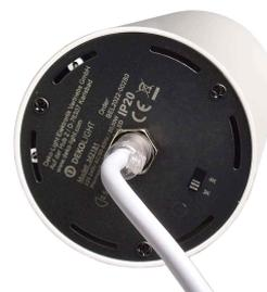
Die Pendelleuchten der LUCEA-Serie sind in den Versionen 10, 15, 20 W erhältlich und bieten bis zu 2.000 Lumen Lichtleistung. Die maximale Abhängung beträgt 1.600 mm. Über optionale Linsen lassen sich die einzelnen Modelle in ihrem Abstrahlwinkel verengen oder erweitern. Das Gehäuse der LUCEA-Leuchten besteht aus Aluminium-Druckguss.
