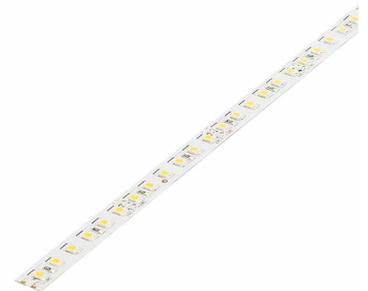
Flexibler LED Strip in 3 m Länge zum Anschluss an 24V Gleichspannungsnetzteile. Zur einfachen Montage ist die Rückseite mit Klebeband ausgestattet. Zu den in mehreren Lichtfarben verfügbaren Strips. Um bei größeren Längen gleichbleibende Lichtleistung zu erhalten, sollten die Strips beidseitig eingespeist werden. Hoher Farbwiedergabindex von über 90. Ab einer Länge von 3 m muss neu eingespeist werden.
