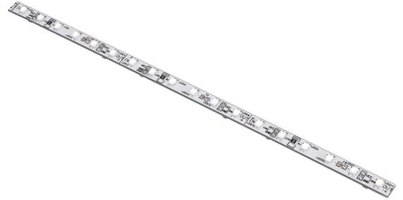
Starrer LED Strip zum Anschluss an 24V Gleichspannungsnetzteile. Zu den in mehreren Lichtfarben verfügbaren Strips sind als Zubehör Einspeisekabel, starre und flexible Verbinder verfügbar. Zur Erleichterung der Montage sind Befestigungsclips erhältlich. Der gewichtete Verbrauch liegt bei 3kWh/1000h.
