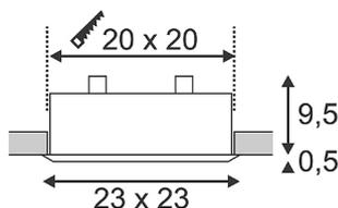
Die Niedervolt Wand- und Deckeneinbauleuchte AIXLIGHT MOD verfügt über kardanisch schwenkbare Lampenhalter und ist für den Einsatz von Niedervolt Halogenleuchtmitteln des Typs MR16 konzipiert. Die innere Seite des Leuchtengehäuses aus Aluminium und Stahl wurde schwarz lackiert, was dem Betrachter ein Bild frei schwebender Leuchtenköpfe vermittelt. Der silbergraue Rahmen rundet die AIXLIGHT MOD optisch ab. Zum Betrieb der Leuchte wird ein passender Transformator mit 12V Wechselspannung benötigt.
