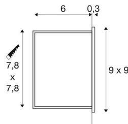
Aluminium Wandeinbauleuchte MOBALA WL. Die nicht sichtbar verbauten LED gibt ihr Licht indirekt an die zu beleuchtende Fläche ab. Dadurch wird eine blendfreie Beleuchtung, beispielsweise von Gehwegen und Treppen ermöglicht. Die MOBALA Einbauleuchte ist erhältlich in weißer Gehäusefarbe. Ein Einbaurahmen sowie eine Einbaudose für die Montage in Mauerwerk sind optional erhältlich. Diese Leuchte enthält eingebaute LED-Lampen.
