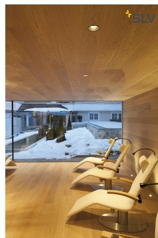
Starre Hochvolt Einbauleuchte der HORN Serie. Bei der aus Stahl gefertigten Leuchte ist das Leuchtmittel nach hinten versetzt eingebaut. Durch diese Bauweise ergibt sich eine besondere Optik. Des Weiteren sind mehrflammige sowie Niedervolt Versionen verfügbar.
