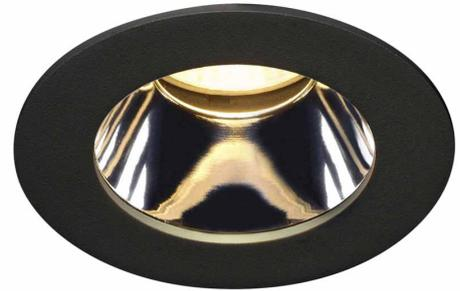
Die H-LIGHT 3 Einbauleuchten Serie überzeugt durch ihre schlichte und elegante Bauform, das integrierte warmweiße LED-Modul sorgt mit seinem schmalen Abstrahlwinkel von 20° für eine dezente und Ambiente orientierte Ausstrahlung. Dank des im Set enthaltenen LED Treibers ist die Leuchte direkt anschlussfertig für 230 V Netzspannung.
