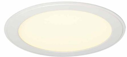
Die SENSER 24 Einbauleuchte aus Aluminium ist erhältlich in den Farben weiß und silbergrau sowie mit runder- und eckiger Blende. Der starre Premium LED-Einsatz ermöglicht durch den Abstrahlwinkel von 120° eine flächige, homogene Grundbeleuchtung. Zum Betrieb der Einbauleuchte wird ein passender Konstantstromtreiber mit 350mA benötigt.
