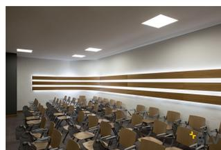
Mit dem zwischen zwei Lichtfarben schaltbaren LED PANEL für Rasterdecken, bieten wir eine moderne und raumsparende Lösung für eine effiziente Art der Grundbeleuchtung. Mit diesem Produkt erreichen Sie ein angenehmes, homogenes und blendfreies Beleuchtungsempfinden. Hier wird ein Blendwinkel unter 19° erreicht.
