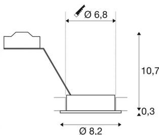
Die runde Hochvoltversion unserer beliebten NEW TRIA Einbauleuchten Serie ist erhältlich in den Gehäusefarben weiß, schwarz und aluminium gebürstet. Der Schwenkbereich des Einbaustrahlers garantiert Ihnen die individuelle Ausrichtung des Lichtkegels, ganz gleich ob Sie sich für den Einsatz von Halogen- oder LED Retrofit-Leuchtmitteln entscheiden. Die speziell für 68mm Lochdurchmesser konzipierte NEW TRIA 68 Einbauleuchte wird fertig für den direkten Anschluss an 230V Wechselspannung geliefert.
