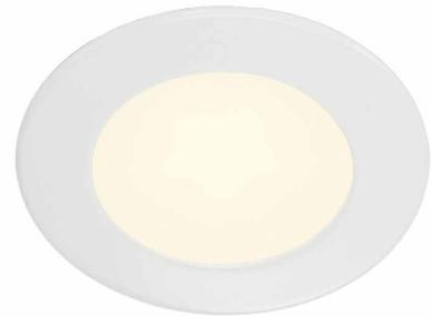
Die DL 126 Einbauleuchte besticht durch ihre geringe Höhe und ist daher optimal für den Einsatz bei geringen Einbautiefen geeignet. Die sechs langlebige SMD LED mit einer Gesamtleistung von 3W sorgen für die nötige Beleuchtungsstärke. Verfügbar ist die Einbauleuchte in weiß, chrom und metall gebürstet. Zum Betrieb wird ein passendes 12V Gleichspannungsnetzteil benötigt. Diese Leuchte enthält eingebaute warmweiße LED-Lampen. Die Lampen können in der Leuchte nicht ausgetauscht werden.
