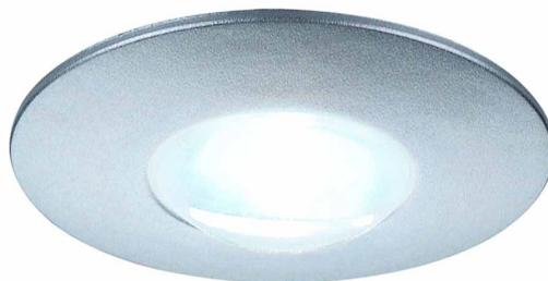
Der starre LED Einbauspot DEKLED wurde aus Aluminium hergestellt und ist die LED-Lichtlösung für Anwendungen bei denen punktuelle Akzentbeleuchtung und geringe Einbautiefe benötigt werden. Die wahlweise neutral- oder warmweiße 1W LED sorgt für die benötigte Beleuchtungsstärke. Zum Betrieb des Spots wird ein passender Konstantstromtreiber mit 350mA benötigt. Die Lampen können in der Leuchte nicht ausgetauscht werden.
