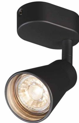
Wand- und Deckenleuchte der AVO Serie bei der die je nach Version ein bis vier Leuchtenköpfe dreh- sowie schwenkbar an der Rosette montiert sind. Die aus Aluminium gefertigte Leuchte ist durch den verbauten GU10 Sockel für Halogen- sowie LED-Leuchtmittel geeignet. Der elektrische Anschluss der in mehreren Farbversionen verfügbaren Leuchte erfolgt direkt an 230V Netzspannung. +
