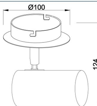
Flexibler Spot - Die Deckenaufbauleuchte Indi I verfügt über ein silberfarbenes Aluminiumgehäuse in gebürsteter Optik, in dem sich ein GU10-Leuchtmittel mit max. 50 Watt befindet. Durch die dreh- und schwenkbaren Elemente lässt sich der Spot flexibel ausrichten und als vielseitige Deckenleuchte verwenden.
