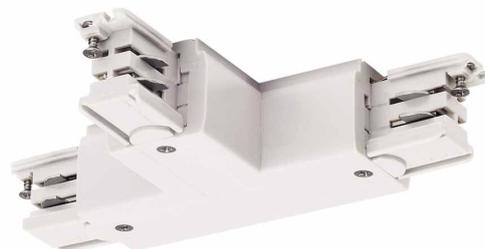
T-Verbinder mit Einspeisemöglichkeit für das Hochvolt 3Phasen-Aufbauschielen-System. Der in mehreren Farbversionen verfügbare Verbinder ist mit Erdleiter links oder rechts erhältlich. Detaillierte Informationen entnehmen Sie bitte der Planungshilfe. Bitte beachten Sie, dass sich der Weißton ab dem 01. Oktober 2018 von RAL 9010 auf RAL 9016 (Verkehrsweiß) ändert.
