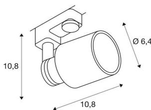
Dreh- und schwenkbarer Hochvoltstrahler PURI TRACK mit passendem Adapter für das 3Phasen Hochvolt-Schienen-System. Die aus Aluminium gefertigte Leuchte ist durch den verbauten GU10 Sockel für Halogen- sowie LED-Leuchtmittel geeignet.
