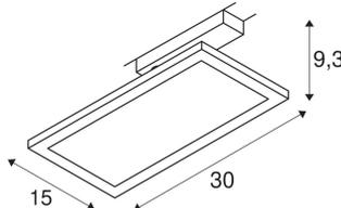
Modern und raumsparend zugleich, sorgt PANEL für eine effiziente Grundbeleuchtung. Mit 1.800 Lumen und 3.000 Kelvin erzeugt die 1 Phasen System Leuchte LED ein angenehmes, homogenes und blendfreies Licht. Hinzu kommen die robuste Bauweise der aus Polycarbonat (PC) und Stahl gefertigten Leuchte und die lange LED Lebensdauer von 50.000 Stunden. Erleben Sie PANEL im Einsatz und überzeugen Sie sich von einem gelungenem Erlebnis Licht.
