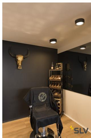
Die Hochvolt LED Deckenleuchte FERA 25 überzeugt durch ihr einfaches klares Design und die hohe Leuchtkraft. Die verbauten LED erreichen einen ausgezeichneten Lichtstrom. Somit kann die Leuchte bedenkenlos zur allgemeinen Raumbeleuchtung eingesetzt werden. Dank des eingebauten LED Treibers, ist die Leuchte fertig für den direkten Anschluss an 230V Wechselspannung. Diese Leuchte enthält eingebaute LED-Lampen.
