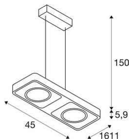
Mit Ihrem zeitlosen und modernen Design, in den Farben schwarz und weiß, sowie ihrer Effizienz, ist die Leuchten-Serie LYNAH eine innovative Beleuchtungsmöglichkeit für sämtliche Bereiche. Die Lampenhalter sind kardanisch schwenkbar und ermöglichen die individuelle Ausrichtung der Lichtkegel. Die Leuchte verfügt über dimmbare LED-Module mit einem Abstrahlwinkel von je 24° und ist für den direkten Netzanschluss an 230V geeignet.
