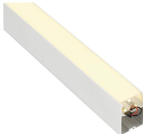
Großzügig gestaltetes Aluminium Wand- und Deckenaufbauprofil GLENOS zum parallelen einlegen von zwei LED Strips in der oberen Ebene sowie eines Netzteiles in der unteren Ebene. Durch die im Lieferumfang enthaltene, satinierte Acrylglasabdeckung erfolgt der Lichtaustritt sehr weich. Über ein optional erhältliches Abhänge-Set kann das in mehreren Farben und Längen verfügbare Profil bis zu 2,5m ab gependelt werden.
