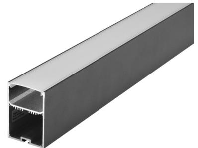
Großzügig gestaltetes Aluminium Wand- und Deckenaufbauprofil GLENOS zum parallelen einlegen von zwei LED Strips in der oberen Ebene sowie eines Netzteiles in der unteren Ebene. Durch die im Lieferumfang enthaltene, satinierte Acrylglasabdeckung erfolgt der Lichtaustritt sehr weich. Über ein optional erhältliches Abhänge-Set kann das in mehreren Farben und Längen verfügbare Profil bis zu 2,5m ab gependelt werden.
