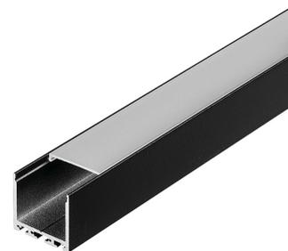
GLENOS Profi-Profil 3030 in 100 cm Länge exklusive Abdeckung zur Montage von LED Strips bis 30 mm Breite. Das in schwarz matt, weiß matt und silber erhältliche Profil kann als Einbau-, Aufbau oder samt optionalem Abhängeset 213488 auch als Pendelvariante eingesetzt werden.
