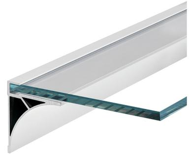
GLENOS Regal-Profil in 60 cm Länge zur Montage von Glasböden in 0,8 cm Dicke und max. 18 cm breit mit darunter befestigtem LED-Strip. Glas und LED Strip nicht im Lieferumfang enthalten. Empfohlen zur Befestigung mit 3 Senkkopfschrauben.
