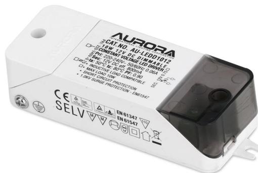
10W, 12V, DC, dimmbarer LED-Treiber mit Konstantspannung. Dimmbarer LED-Treiber für den Gebrauch mit Aurora Premium, Standard & Contractor 12V dimmbaren LED-Lampen. Die LED-Leuchten müssen mehr als eine LED haben, um das Dimmen zu ermöglichen. Dimmbar mit AU-DSP Dimmern (mit einer Leistungsreduzierung auf 50%). Überlastschutz / Kurzschlusschutz / Thermo-Schutz, 1,0 KV ÜBERSpannungSSCHUTZ - EN 61547 Sicherheitskonform - EN 61347 EMC-konform - EN 55015, EN 61000, EN 61547. 3 Jahre Garantie
