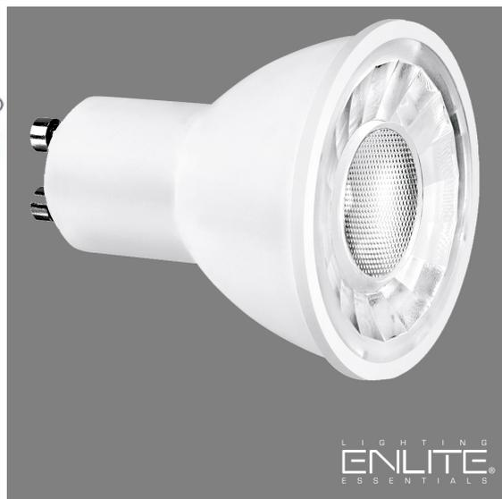
Die neue ICE+ Serie besticht durch eine ausgesprochen gute Farbwiedergabe mit Ra 90 und ermöglicht eine farbgetreue Darstellung von Objekten, Handelswaren und deren Umfeld. Integrierte Elektronik mit hohem Leistungsfaktor verbessert die Energieeffizienz und reduziert den Stromverbrauch. Die ICE+ erhalten Sie wahlweise als standard oder dimmbare Version
