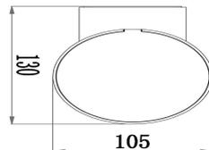
Die LED-Wandaufbauleuchte SEGIN eignet sich für den vielseitigen Outdoor-Einsatz und erhellt Außen- sowie Eingangsbereiche von Gebäuden und lässt sich bei Bedarf auch als Hausnummernleuchte einsetzen. Neben dem robusten Aluminium-Druckgussgehäuse verfügt die SEGIN zudem über ein rundes Shutter, über das sich die Lichtrichtung flexibel an die jeweilige Anwendung anpassen lässt.
