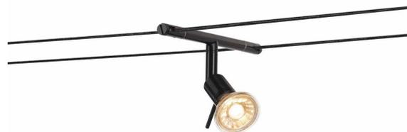
Aus Stahl bestehender, dreh- und schwenkbarer Strahler SYROS für das Niedervolt Seil-System. Durch den verbauten G5,3 Sockel ist der Strahler für Halogen- sowie LED-Leuchtmittel geeignet. Der maximal compatible Seilabstand beträgt 15,5cm.
