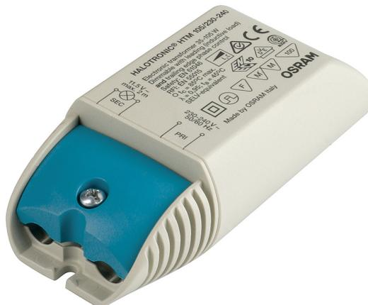
Produkteigenschaften: Netzfrequenz: 50-60 Hz, Funkentstörung: nach EN 55015 (A1: 2007)/ CISPR 15, EN 55022, Netzstromoberwellen: nach EN 61000-3-2, Immunität, Störfestigkeit: nach EN 61547, Sicherheit: nach EN 61347, Galvanische Trennung zwischen Primär- und Sekundärseite, Kurzschlusschutz, Überlastschutz, Übertemperaturschutz: elektronisch reversibel.
