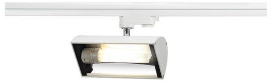
Dreh- und schwenkbarer Hochvoltstrahler NEPRO 2 mit passendem Adapter für das 3 Phasen Hochvolt Schienen-System. Durch die Kombination aus verbautem Vorschaltgerät und G24d-3 Fassung ist die in mehreren Farbversionen verfügbare Leuchte für den Betrieb von kompakt Leuchtstofflampen geeignet. Der werkseitig montierte Reflektor sorgt im Betrieb für einen gleichmäßigen Lichtaustritt.
