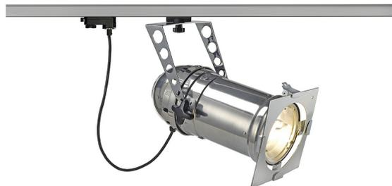
Dreh- und schwenkbarer PAR-Strahler SFL PAR56. Innerhalb des Aluminiumkörpers des PAR Strahlers befindet sich der Rx7s Sockel. Somit ist der Strahler für den Einsatz von Halogenmetall dampflampen geeignet. Das zum Betrieb notwendige Vorschaltgerät ist innerhalb der Leuchte verbaut. Der elektrische Anschluss erfolgt mittels des Adapters für das 3 Phasen Hochvolt Schienen-System. Alternativ sind Versionen für höhere Wattagen bzw. mit G12 Sockel verfügbar.
