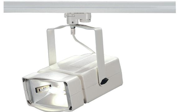
Dreh- und schwenkbarer Hochvoltstrahler SDL 150 mit passendem Adapter für das 3 Phasen Hochvolt Schienen-System. Um diesen Profi-Strahler mit verbautem Rx7s Sockel an jeden Einsatzort anzupassen, sind separat Blendkappen zur perfekten Ausrichtung verfügbar. Das zum Betrieb der Entladungslampe notwendige Vorschaltgerät ist im hinteren Teil der Leuchte verbaut.
