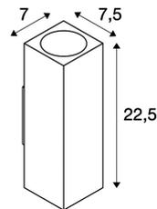
Wandleuchte der THEO Serie gefertigt aus Aluminium und Glas welches die Leuchtmittel abdeckt. Dank der Position der zwei verbauten Fassungen, erzeugt die montierte Leuchte zwei gleiche, jedoch entgegengesetzte Lichtkegel (UP/DOWN). Durch die Schutzart IP44 ist sie für den Außenbereich geeignet. Der elektrische Anschluss der in drei Farbversionen verfügbaren Leuchte erfolgt an 230V Netzspannung. Die THEO Serie beinhaltet des Weiteren Deckenleuchten und ist somit universell einsetzbar. +
