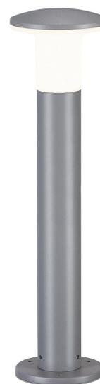
Die aus Aluminium gefertigte Stehleuchte ALPA MUSHROOM gibt Ihr Licht über einen opalen, pilzförmigen Leuchtenkopf aus PC ab. Durch die Schutzart IP55 ist sie für den Außenbereich geeignet. Als optionales Zubehör für die verfügbaren Farb- sowie Größenversionen sind Erdspeiß, Betonanker-Set, Stockschrauben-Set sowie eine Verbindungsbox zum sicheren, elektrischen Anschluss im runden Leuchtschaft verfügbar. Der Anschluss erfolgt jeweils an 230V Netzspannung.
