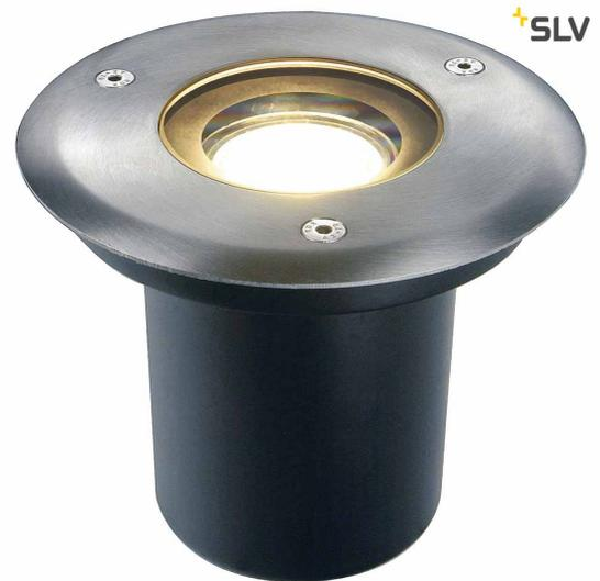
Die begehbare Hochvoltbodeneinbauleuchte mit runder Edelstahlblende und teilsatinierter Glasabdeckung ist mit einer GU10 Fassung ausgestattet und somit kompatibel mit Halogen-, bzw. LED Lampen. Durch die Schutzart IP67 ist die Leuchte für den Außenbereich geeignet. Der elektrische Anschluss erfolgt direkt an 230V Netzspannung. Zur einfachen Montage befindet sich ein Einbautopf im Lieferumfang. Alternativ zum Boden, kann die Leuchte auch in die Wand eingelassen werden. +
