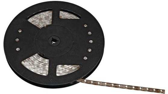
Kunststoffummantelter, flexibler 12V DC LED Strip der Outdoor Serie. Zur einfachen Montage ist die Rückseite mit Klebeband ausgestattet. Der elektrische Anschluss des in mehreren Längen und Lichtfarben verfügbaren Strips erfolgt mittels 50cm Zuleitung an ein kompatibles 12V Gleichspannungsnetzteil. Durch die Schutzart IP55 ist der Strip auch für den Außenbereich geeignet.
