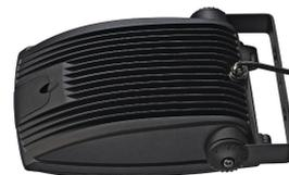
Leistungsstarker LED OUTDOOR Strahler zur Beleuchtung von Flächen und Plätzen. Durch den schwenkbaren Montagebügel sowie die Schutzart IP65 ist der Strahler für die Außenmontage an Wand, Decke und Boden geeignet. Der elektrische Anschluss des in warm- und neutralweiss verfügbaren Strahlers erfolgt durch den verbauten Treiber sowie der Zuleitung inkl. Netzstecker direkt an 230V Netzspannung. Zur einfachen Montage sind optional ein Erdspieß sowie ein Wandausleger erhältlich.
