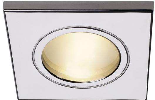
Der DOLIX OUT Niedervolt Deckeneinbauring ist aus Aluminium gefertigt und mit einem Glas zum Schutz gegen Spritzwasser ausgestattet. Mit seiner Schutzart IP65 ist er im Außenbereich oder in Feuchträumen einsetzbar. Zum Betrieb des Downlights wird ein passender Transformator für Niedervolt Halogen Leuchtmittel benötigt.
