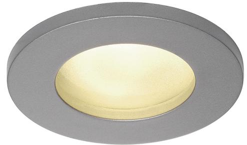
Der DOLIX OUT Hochvolt Deckeneinbauring ist aus Aluminium gefertigt und mit einem Glas zum Schutz gegen Spritzwasser ausgestattet. Mit seiner Schutzart IP44 ist er im Außenbereich oder in Feuchträumen einsetzbar. Dank der eingebauten GU10 Hochvoltfassung ist der DOLIX OUT Deckeneinbauring fertig für den direkten Anschluss an 230V Netzspannung.
