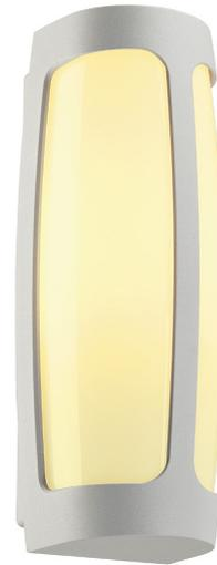
Aus Aluminium gefertigte Wand- und Deckenanbauleuchte der MERIDIAN Serie mit opaler PC Leuchtfläche. Durch die Schutzart IP54 ist die in mehreren Farbversionen verfügbare Leuchte für den Außenbereich geeignet. Der elektrische Anschluss erfolgt direkt an 230V Netzspannung. Die MERIDIAN Serie beinhaltet des Weiteren alternative Wandleuchten in unterschiedlichen Designs.
