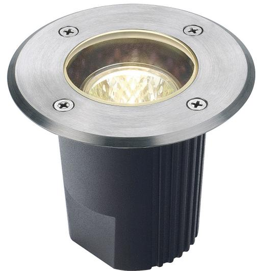
Die begehbare Niedervoltbodeneinbauleuchte mit runder Edelstahlblende und teilsatinierter Glasabdeckung ist mit einer GU5,3 Fassung ausgestattet und somit kompatibel mit Halogen-, bzw. LED Lampen. Durch die Schutzart IP67 ist die Leuchte für den Außenbereich geeignet. Der elektrische Anschluss erfolgt an einem separat erhältlichen 12V Niedervolttrafo. Zur einfachen Montage befindet sich ein Einbautopf im Lieferumfang.
