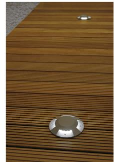
Aus Aluminium gefertigte Abdeckung für LED EINSÄTZE. Verfügbar in Versionen mit ein, zwei oder vier Lichtaustrittsöffnungen. Die Lieferung erfolgt inklusive eines Bodenschuttringes. Die begehbare Abdeckung kann entweder auf dem Boden, an der Wand oder der Decke montiert werden.
